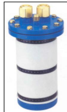
No separador, a mistura de óleo e fluido refrigerante quente vindo do compressor entra e atravessa um tubo perfurado. A mistura bate contra a tela onde o óleo geralmente se separa do vapor. O óleo é drenado pela parte inferior da tela para um pequeno reservatório no separador. O vapor passa através da tela e deixa o separador pela parte superior. Quando o nível do óleo sobe no reservatório, a bóia do flutuador também sobe e o óleo volta ao compressor através de um orifício.
