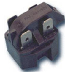
Diz-se que o PTC se encontra em funcionamento normal quando sofre um aquecimento devido a uma corrente elétrica que passou por ele na partida e, neste caso, o valor da resistência se eleva, impedindo a passagem de corrente elétrica para a bobina auxiliar e o motocompressor segue funcionando somente com a bobina de marcha energizada.
